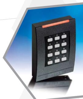
Les lecteurs RK40 et RWK400 de HID utilisent la technologie iCLASS de cartes à puce sans contact 13,56 MHz. Ils permettent de réaliser une authentification par présentation d'une carte, saisie d'un code au clavier ou la combinaison des deux.
