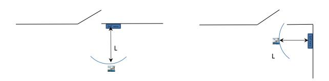
Le bas de l'antenne doit être positionné à une distance d, d'environ 1m20 du sol. Dans ce cas, la distance de détection, L, lorsque le badge est présenté face au lecteur est, en fonction des identifiants utilisés<sup>(1)</sup>:
