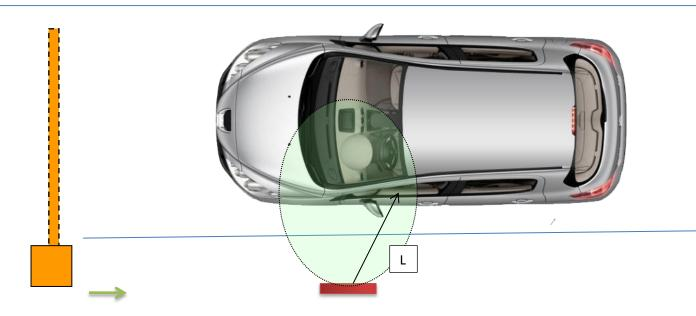
Le bas de l'antenne doit être positionné à une distance d, d'environ 1m20 du sol. Dans ce cas, la distance de détection, L, lorsque le badge est présenté face au lecteur est, en fonction des identifiants utilisés<sup>(1)</sup>:
